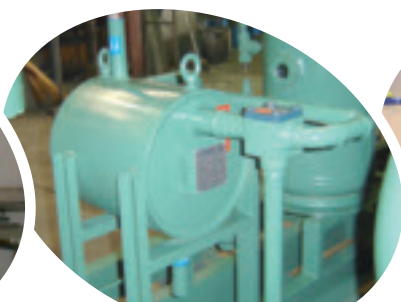
Enfriadores de aceite
